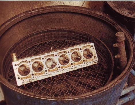
So sieht eine Motorenwaschmaschine aus: Der von Öl und Schmutz überzogene Kopf rotiert rund zehn Minuten lang auf einem Drehgitter. Dort wird er von einer heißen Mischung aus Wasser und speziellen Reinigungsmitteln bestrahlt. Das löst den Schmutz vom Aluminium
