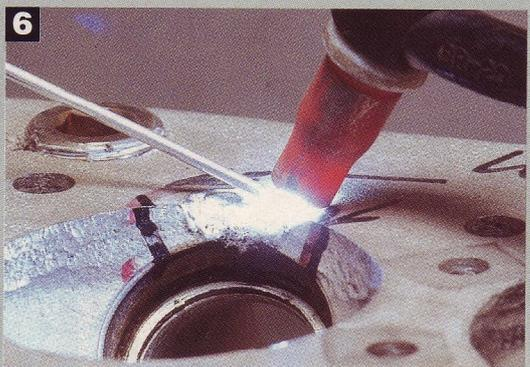
Bevor der eigentliche Materialaufbau erfolgt, muss die gesamte schadhafte Stelle verschmolzen werden. Kanten würden eine gute Haftung des neuen Materials verhindern, zudem werden auf diese Weise Oxydationsstoffe und Ölablagerungen aus dem Guss herausgespült
