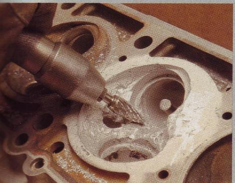
Anschließend wird der zerstörte Bereich „verputzt“, also von Graten befreit und die Oberfläche eingeebnet. Dafür gibt es spezielle Fräseinsätze für Leichtmetalllegierungen, die weniger Zähne haben und sich somit nicht so leicht mit dem weichen Werkstoff zusetzen können
