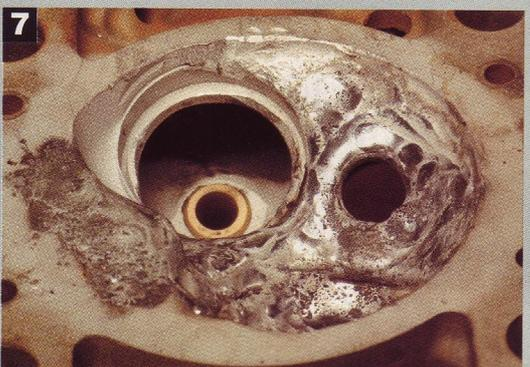
Nach dem langsamen Abkühlen – idealerweise über Nacht in einem erkaltenden Ofen – lässt sich die reparierte Stelle bearbeiten. Auf einer speziellen Ventilfräsbank werden die Aufnahmen für die Sitzringe gefräst. Dann wird der Brennraum mit einer Handfräse bearbeitet
