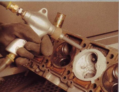
In einer Strahlkabine säubert Glasmehl den Brennraum von den letzten noch verbliebenen Ablagerungen. Die Schadstelle ist jetzt metallisch rein. Ohne vorherige Reinigung in der Motorenwaschmaschine würden die Ölrreste das feine Glasmehl verklumpen und unbrauchbar machen
