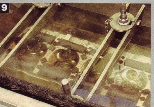
Hat der Kopf die Leckprüfung bestanden, erfolgt das Planen der Dichtfläche. Dabei sollte so wenig Material wie möglich abgetragen werden – mit jedem Zehntel steigt die Kompression. Zum Schluss erfolgen das Nachschneiden der Gewinde und das sorgfältige Spülen und Reinigen
